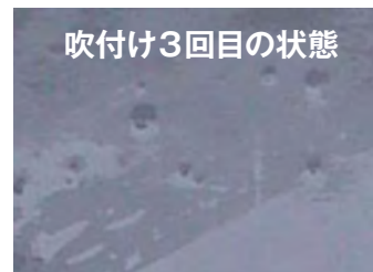
吹付け3回目の状態 ピンホールが発生
